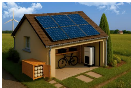
La solución de almacenamiento REMORA Home consta de un compresor reversible y cilindros de aire comprimido.
